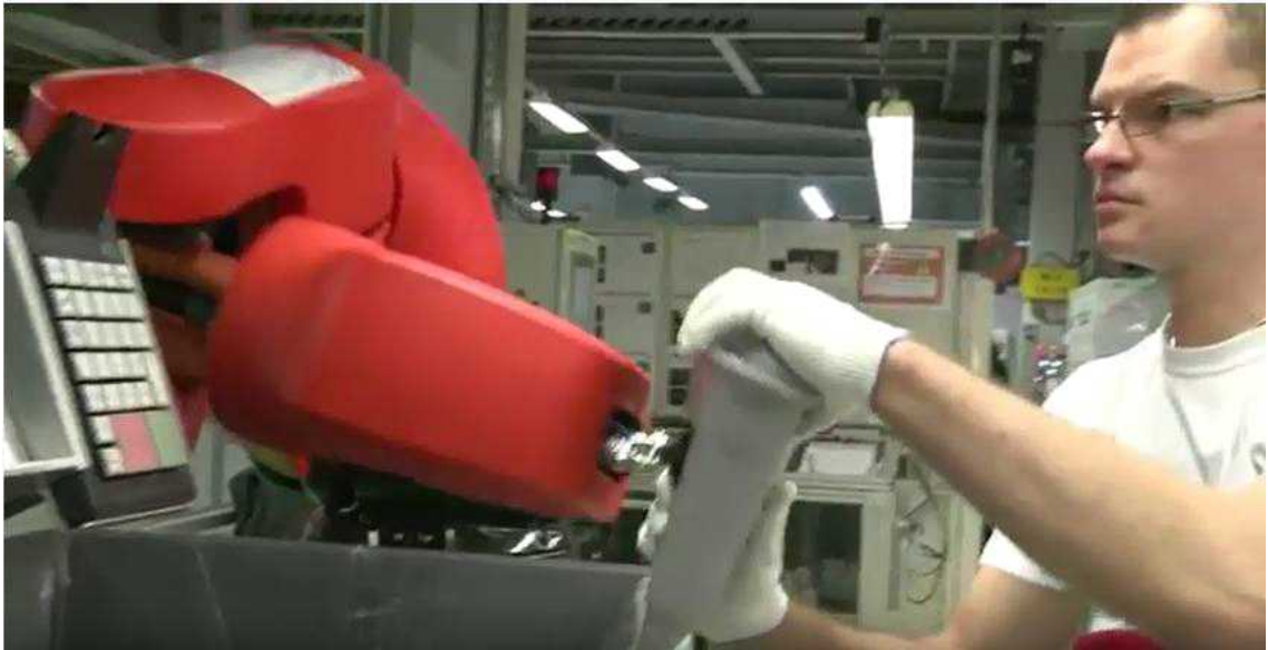
〈그림 II-18〉 협업로봇을 이용한 부품 전달
